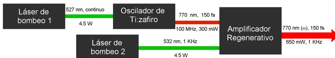
**Figura 2.2.** Sistema de generación de pulsos láser de sub-fs
