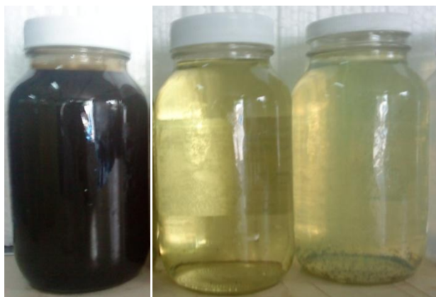
Figura 5. 9 Agua residual aceitosa sin tratamiento (fotografía izquierda) y agua residual aceitosa después del proceso de coagulación-FAD (fotografía derecha).
