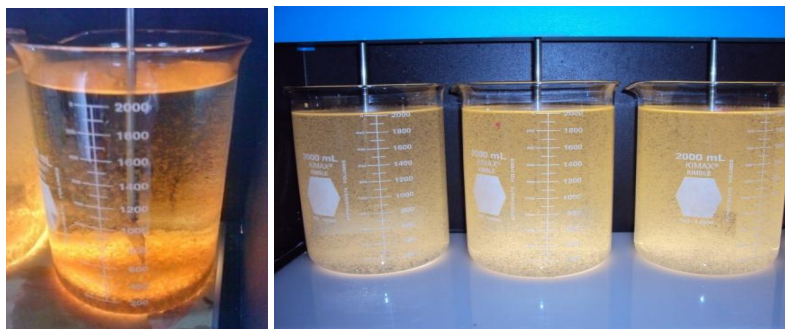
Figura 5.3 Desestabilización de la emulsión aplicando PAX 260 XLS.
