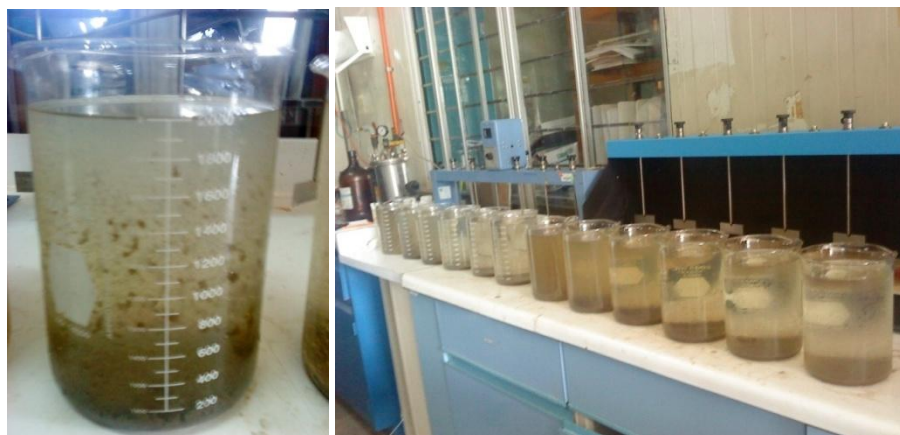
Figura 5. 7 Pruebas con combinaciones de coagulantes y floculantes aniónicos.
