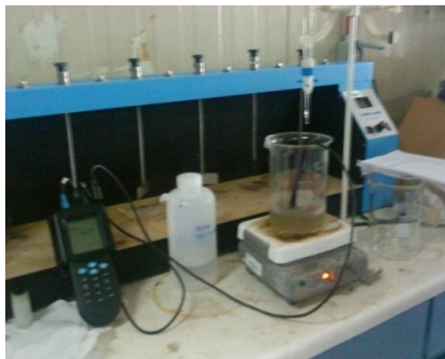
Figura 4. 2 Fotografía del equipo para la determinación de la dosis mínima.
