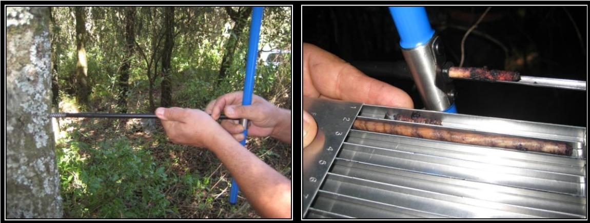
Figuras 4 y 5. Extracción de la viruta por medio de taladro Pressler y su resguardo en estuches metálicos.
