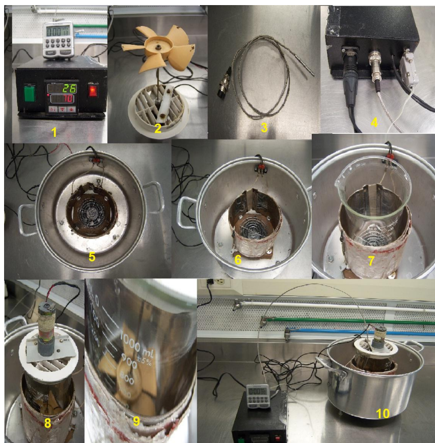
Figura 4.1. Esquema del dispositivo termohidrolizador de lodos. 1: Controlador digital de temperatura y tiempo; 2: agitador tipo propela; 3: termopar; 4: conexiones; 5: ventilador; 6: resistencia eléctrica 200 Watt; 7: reactor de vidrio; 8: acoplamiento de reactor y agitador; 9: volumen útil de 1 litro; 10: sistema ensamblado.
