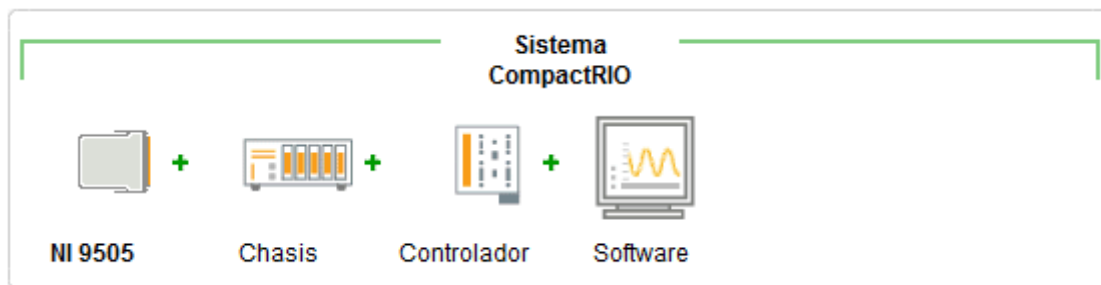
Figura 4.3. Hardware: Sistema CompactRIO completo
