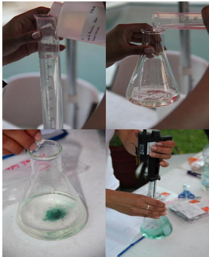
Figura 29. Determinación de dureza y alcalinidad usando equipo HACH.
