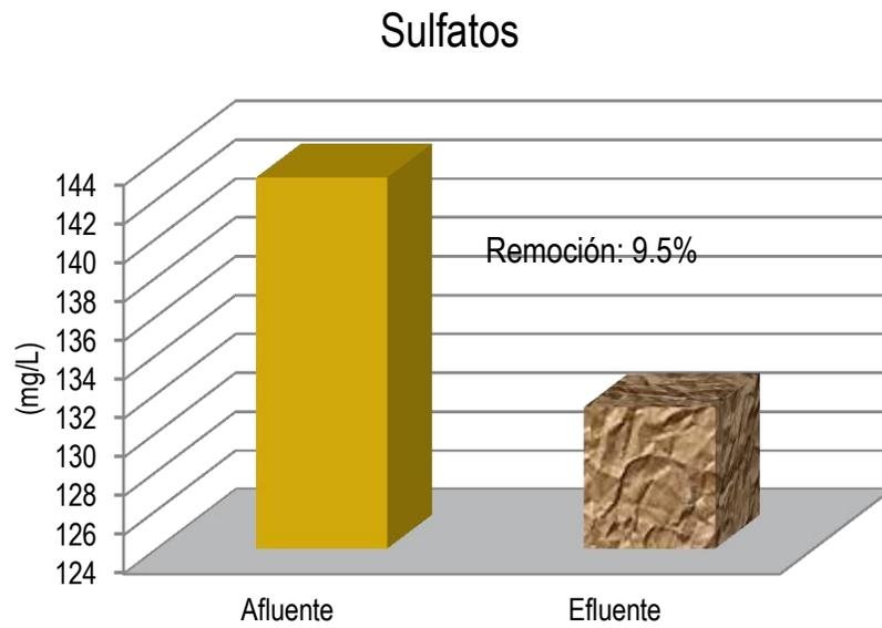
Figura 42. Concentración promedio y variación de sulfatos entre el afluente y efluente del humedal.
