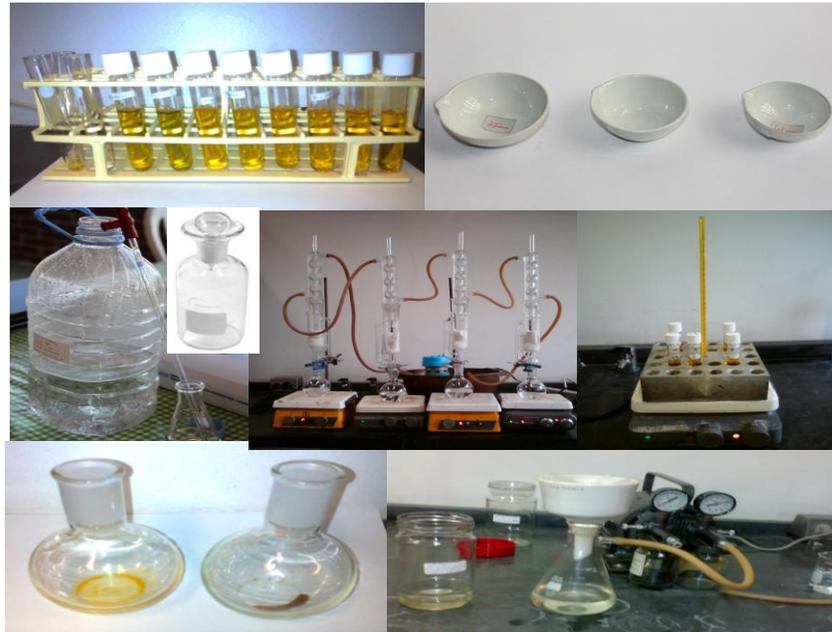
Figura 30. Determinación de sólidos totales, grasas y aceites, DBO<sub>5</sub> y DQO con base en las Normas Oficiales Mexicanas.
