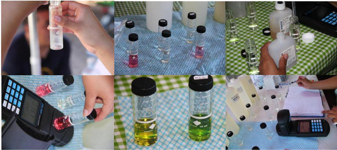
Imagen 28. Determinación de ortofosfatos, nitrógeno amoniacal, sulfatos, sulfuros, nitratos y nitritos usando equipo HACH
