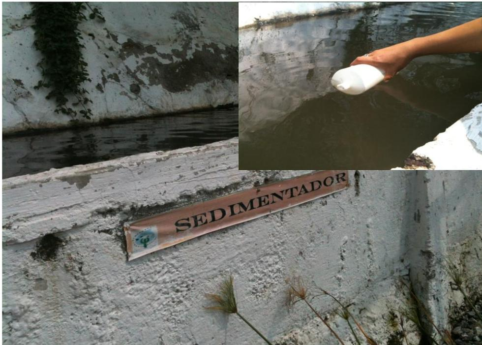
Figura 24. Muestreo en el canal sedimentador (Afluente) del Humedal construido en Ixmiquilpan, Hidalgo.
