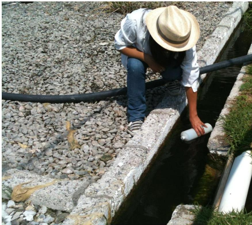
Figura 25. Muestreo en el efluente del Humedal construido en Ixmiquilpan.
