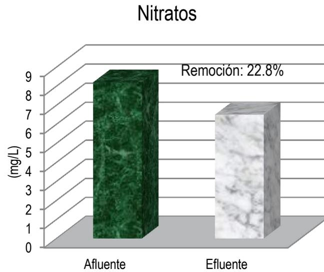
Figura 52. Concentración promedio, variación y porcentaje de remoción de los nitratos entre el afluente y efluente del humedal.
