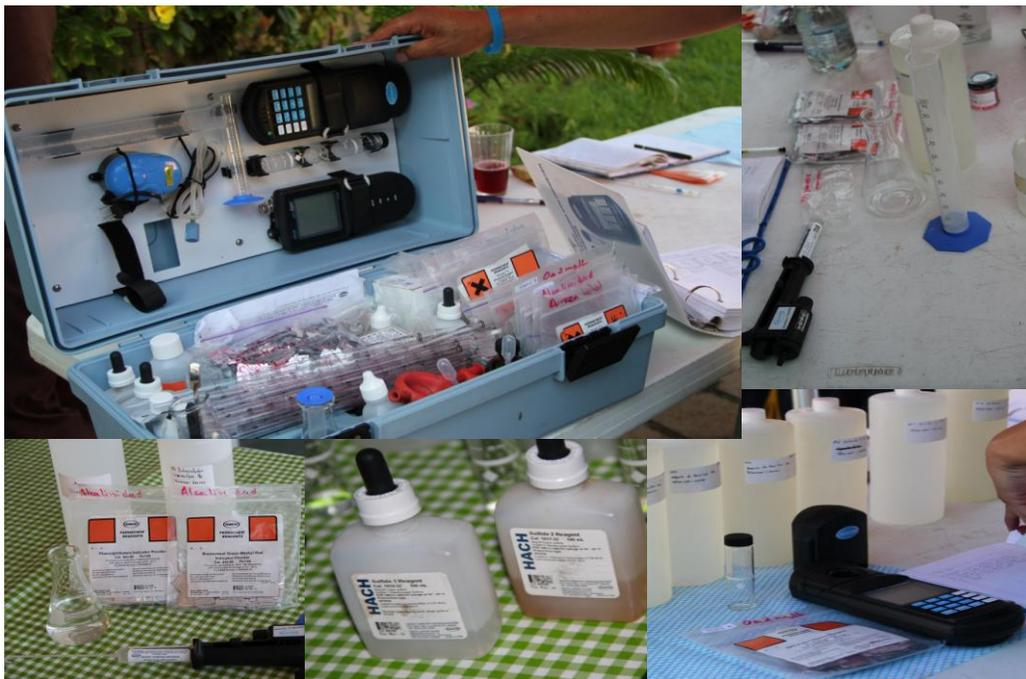
Figura 27. Equipo HACH DR/890 Colorimétrico.
