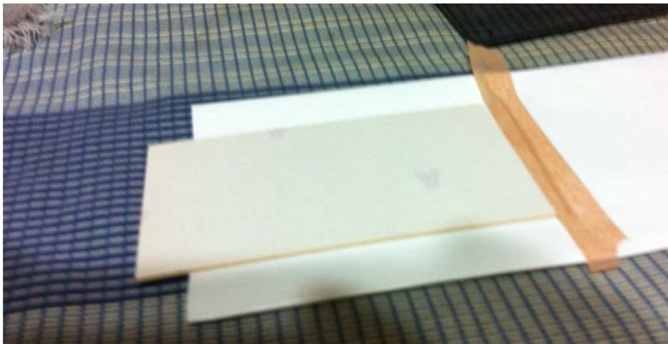
**Fig. 4.5** La hoja con el diseño del circuito se fija por la parte posterior a la tableta
