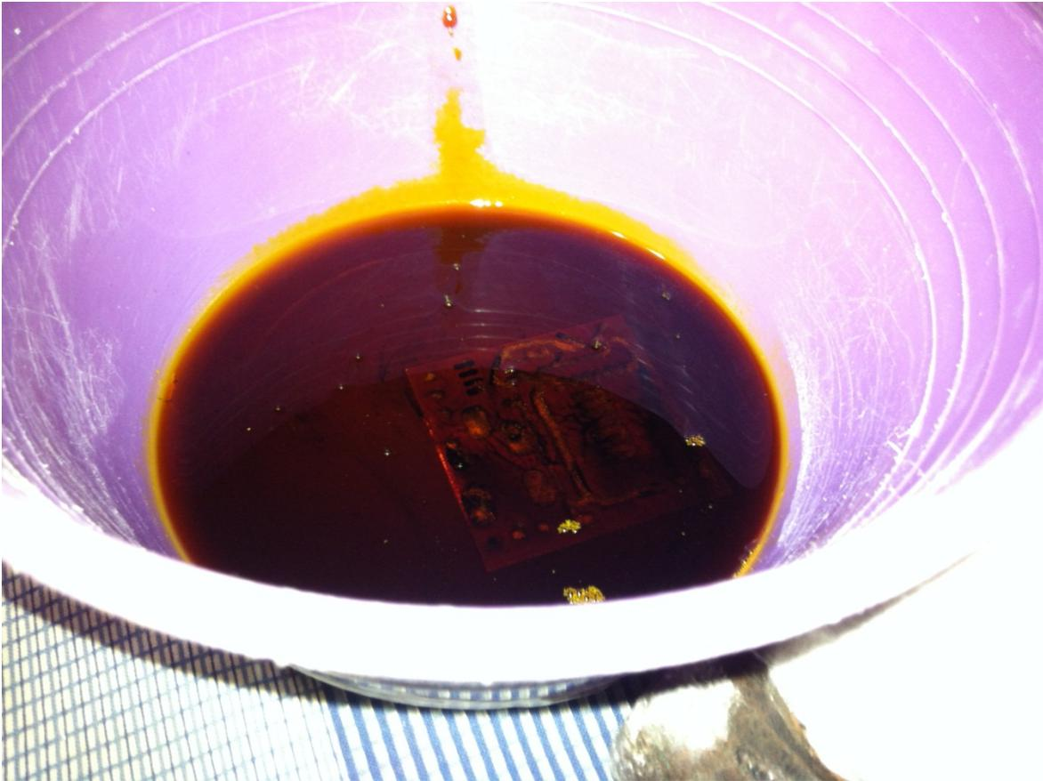
**Fig. 4.10 Circuito sumergido en cloruro férrico.**
