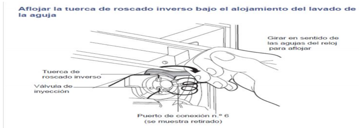
Figura 19. Forma correcta de aflojar la tuerca de roscado inverso.
