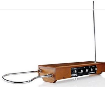
Genera un solo tono, cuya altura y sonoridad se controlan por la proximidad de las manos del intérprete respecto de una antena recta y un bucle, respectivamente, que sobresalen del instrumento.
