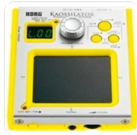
Sintetizador por frases que tiene funciones de caja de ritmos, con el que es posible grabar *loops*. Tiene un pad sensible al tacto al centro con el cual se controlan en sus planos x,y los efectos del sonido.
