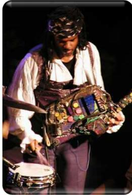
Drumitar, instrumento electrónico que emula sonidos de batería, efectos y voces. El músico mostrado en la imagen ("Future Man" Roy Wooten") desarrolló el aparato con una serie de *triggers* dispuestos en un cuerpo parecido al de una guitarra. Por medio de la pulsación de estos sensores de vibración, se detona un sonido previamente programado por el usuario.
