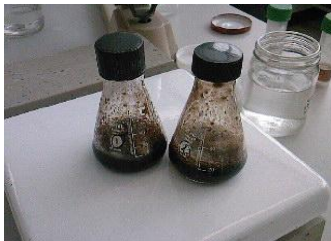
Figura 15. Fraccionamiento de la pared celular de testa de frijol con diferentes disolventes
