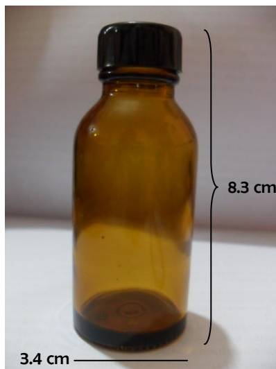
Fig 15. Frasco de vidrio ámbar con tapa de baquelita con capacidad para 60 mL
