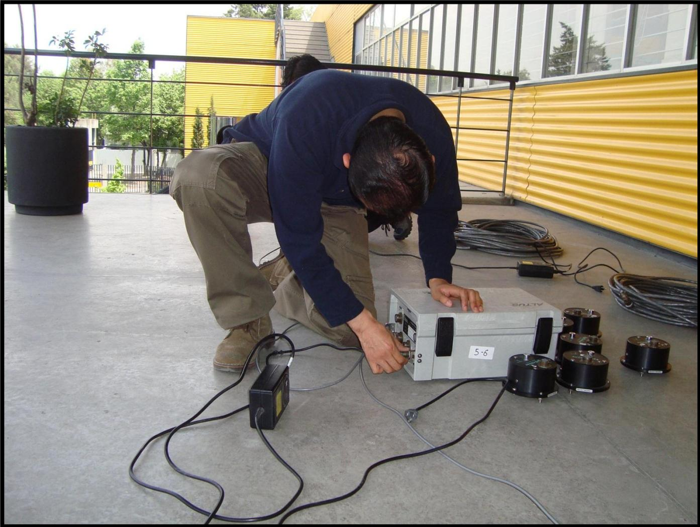
*Figura AF-6 Conexión de cables de conectividad y de alimentación de corriente eléctrica en los adquirentes de datos para la planta de 1<sup>er</sup> nivel*
