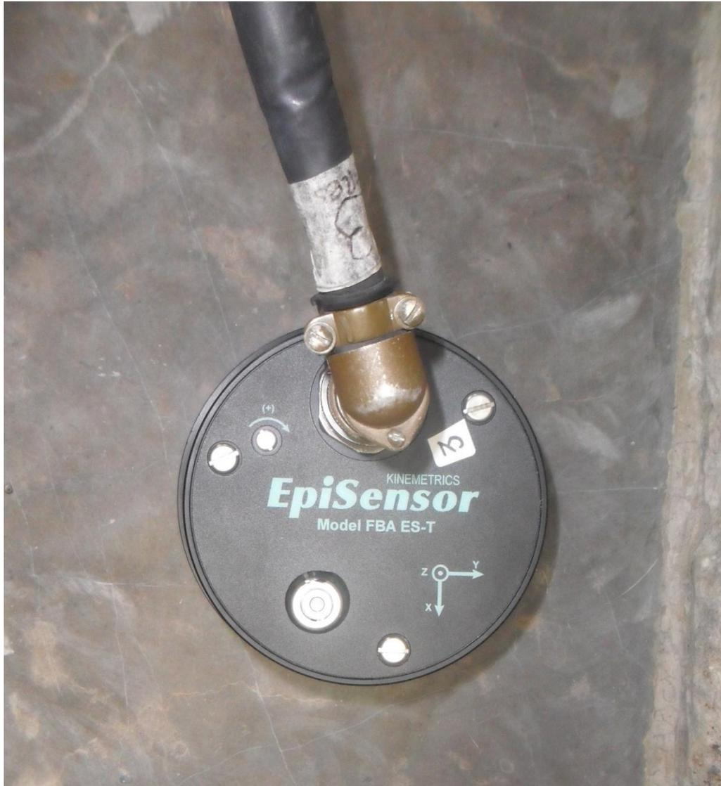
*Figura 4.4 Acelerómetros*
