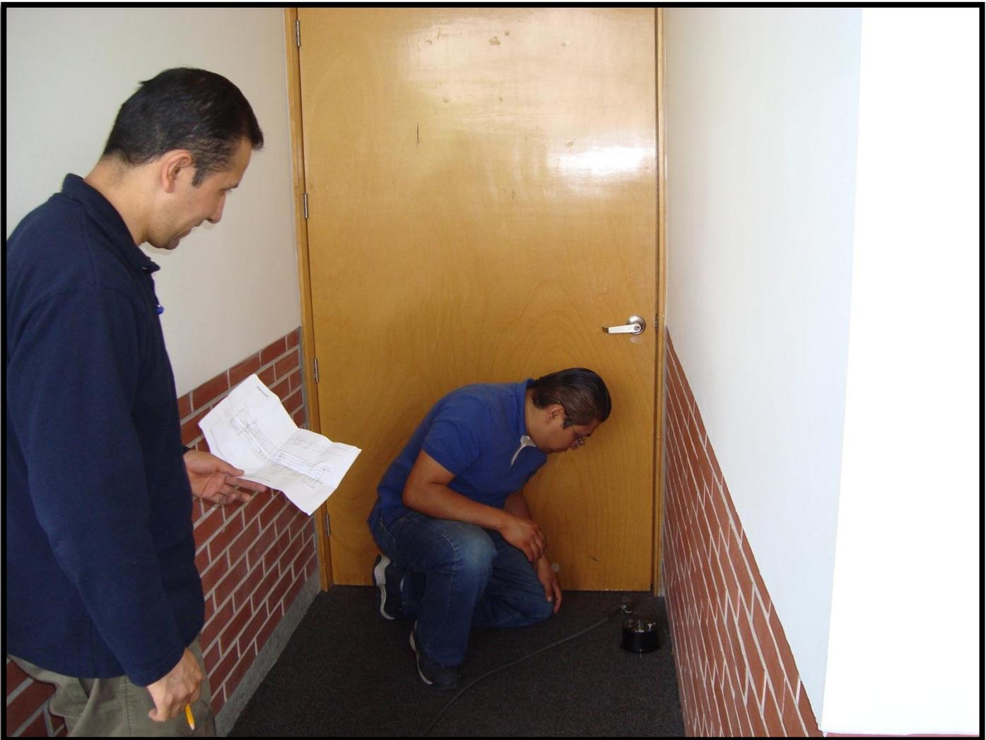
*Figura AF-7 Colocación de los acelerómetros, acelerómetro NI-CC*
