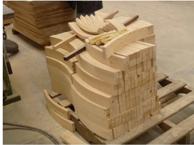
Piezas de respaldo cortadas en sierra cinta copiadora
