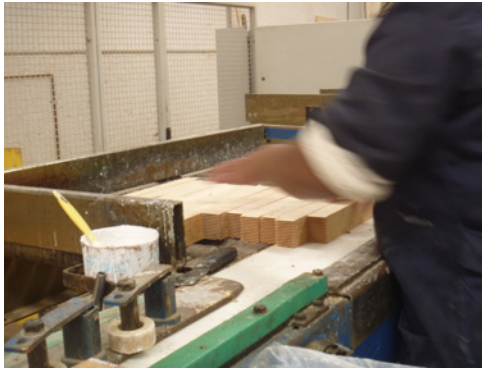
Fabricación de tableros de finger joint
