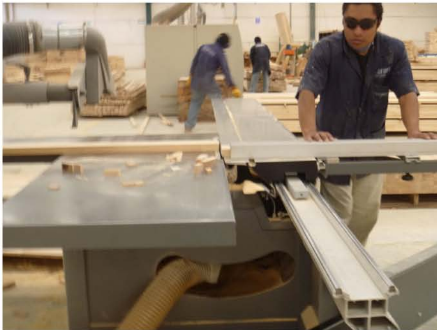
Sierra circular, que realiza los cortes transeversales, y las ranuras.
