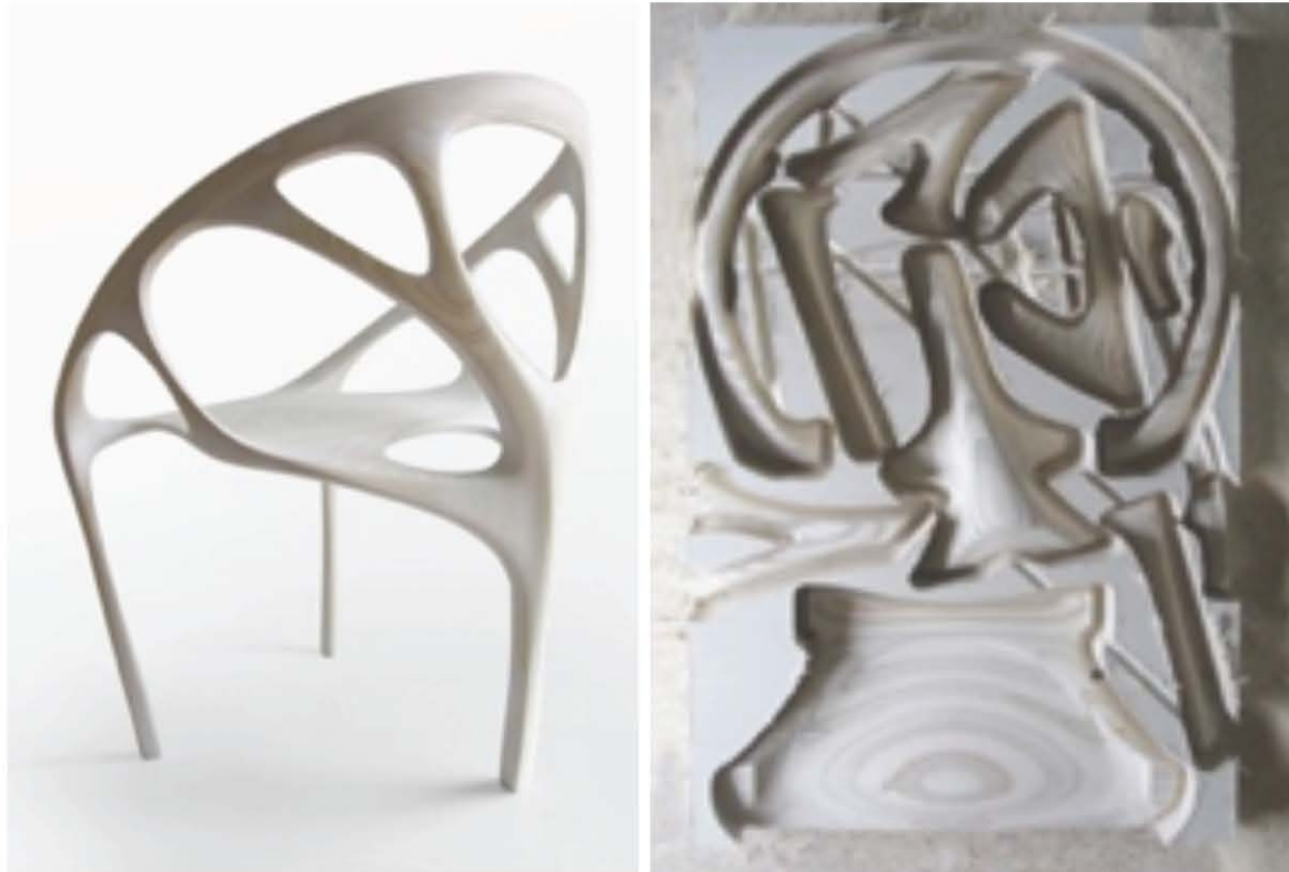
Silla maquinada en CNC y el sobrante del bloque de madera de donde sale
