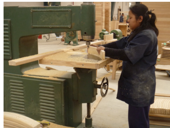
Router Fijo para bolear cantos
