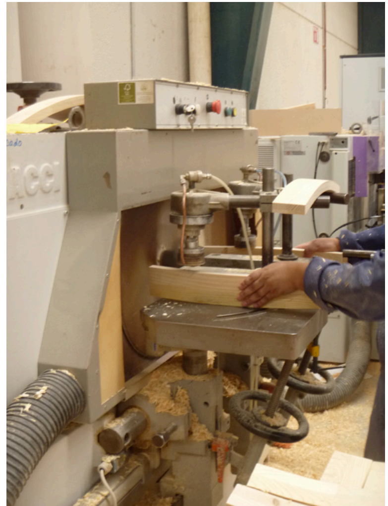
Uso de la espigadora. Crea las espigas de los travesaños, que serán introducidas en las cajas de las patas.
