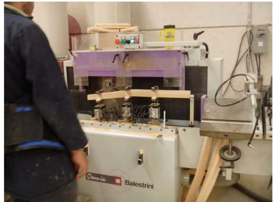
Escopleadora, crea las cajas (Ranuras donde entran las espigas de los travesaños)
