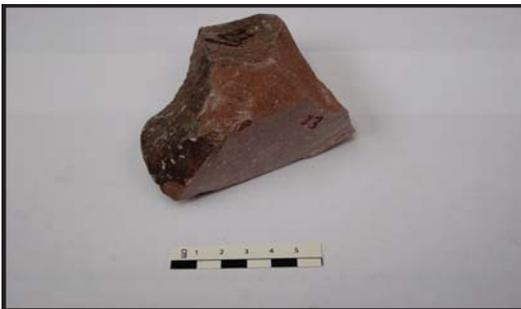
Figura 3.24 Muestra 23, Ignimbrita color rojizo claro, de muy buena calidad, tomada en el punto 274556 E 2176533 N en la Loma cercana al deslizamiento 1.
