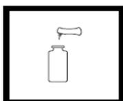
5. Presionar **SHIFT TIMER** Agitar la celda enérgicamente hasta que el cronometro suene en un minuto. Nota: El tiempo y la técnica de agitado influye en el desarrollo del color. Para obtener resultados más exactos realizar pruebas sucesivas en una solución patrón, ajustar el tiempo de agitado para corregir el resultado, Figura (5).
