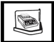
8. Retirar cuidadosamente el tubo del reactor. Colocarlo en un soporte para tubos de ensayo y dejarlo enfriar a temperatura ambiente. Figura (8). **Nota:** Los tubos estarán calientes.
