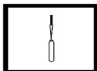
5. Con un embudo, agregar los contenidos de una bolsa de polvo de persulfato de potasio para fosfanato al tubo Figura (5).
