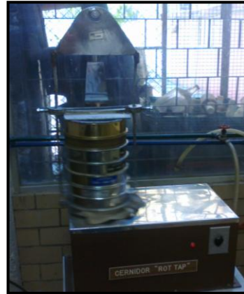
Fig.2.3 ROT-TAP con serie de tamices.
