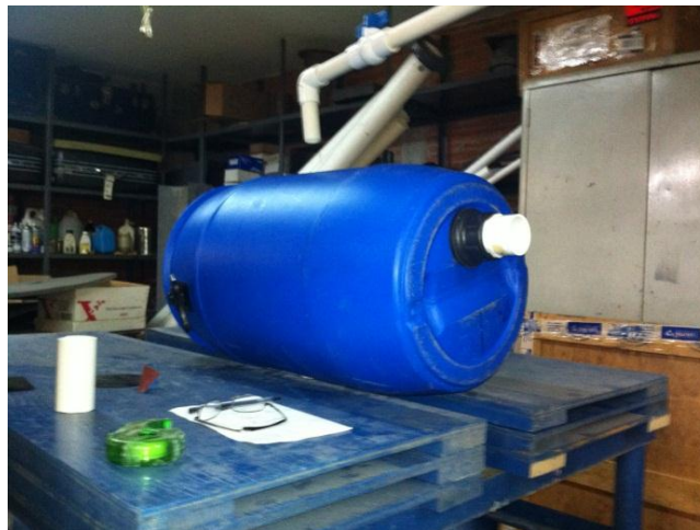
Figura 16. Vista de la salida de agua del tinaco y tablas usadas para incrementar la altura del tinaco.
