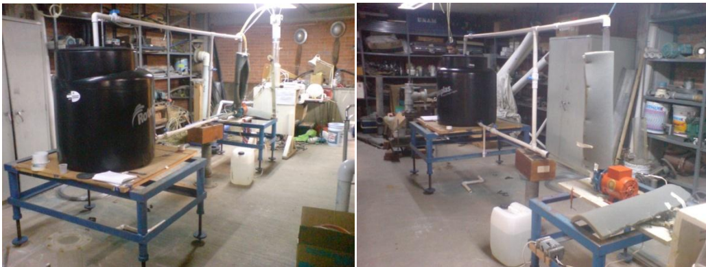
Figura 13. Fotos del circuito hidráulico incrementado en la distancia respecto al tinaco y bomba.
