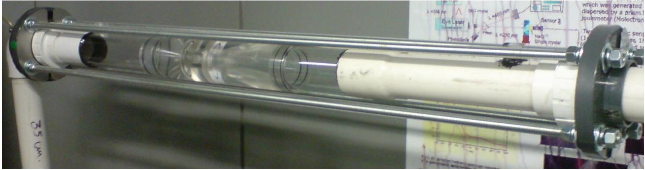
Figura 45. Modificación del accesorio del tubo Venturi.
