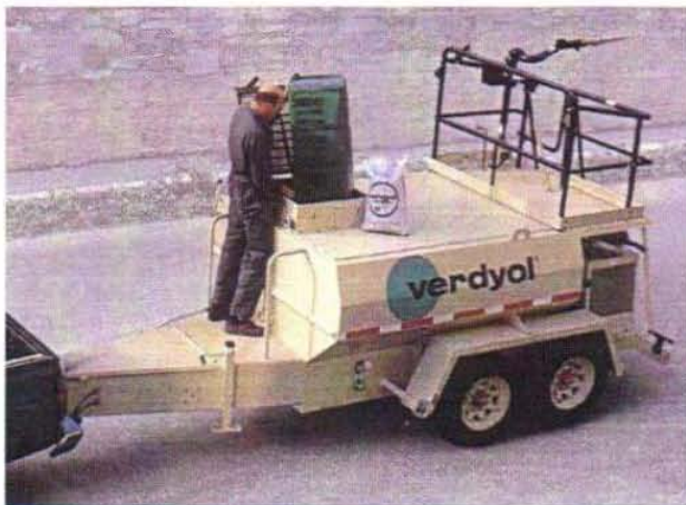
Ejemplo de hidrosiembra con bomba hidráulica
