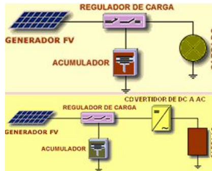
Figura 3.17. Esquema de uso de un sistema fotovoltaico
