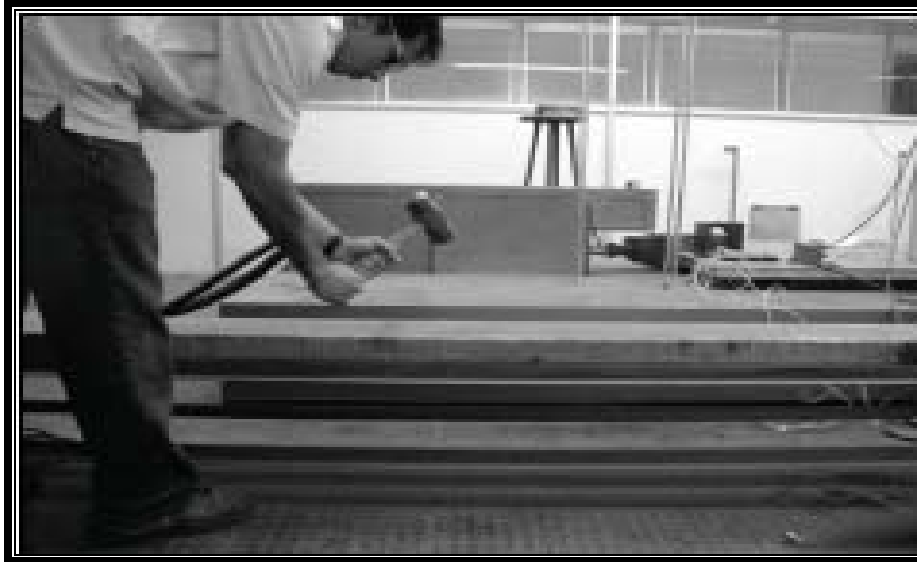
Figura 1.2.7 Golpe de martillo sobre viga.
