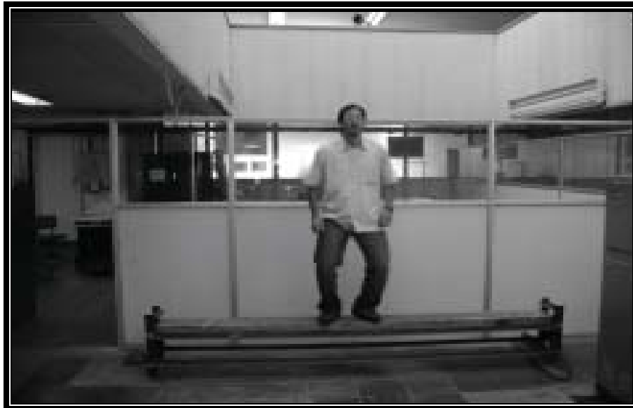
Figura 1.2.8 Persona generando impulsos sobre una viga.
