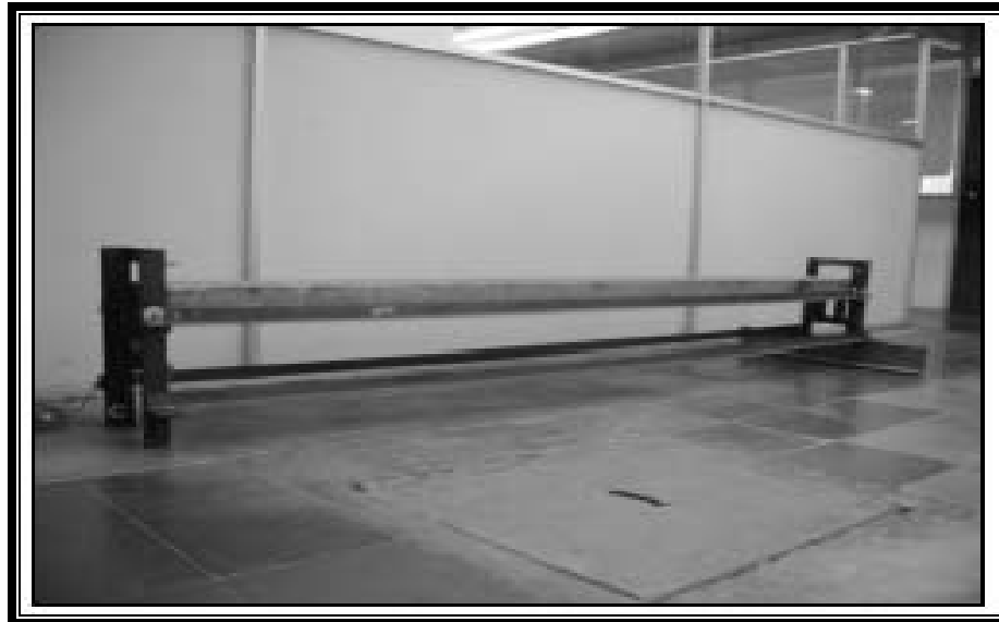
Figura 1.2.4 Viga simplemente apoyada utilizada para el evento.
