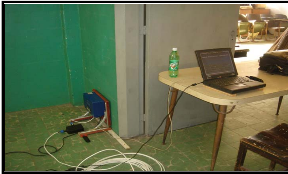
Figura 4.3.2. Forma de colocación de los equipos para registro de señales.
