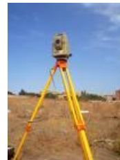
Fig. 70. Estación total sobre tipie.
