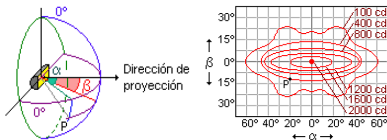
Fig.12 Ejemplo de curvas isocandela para un proyector.
