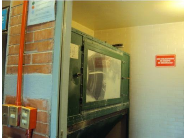
Figura 53. Dispositivo en el cual se coloca la luminaria para realizar la prueba contra el polvo.
