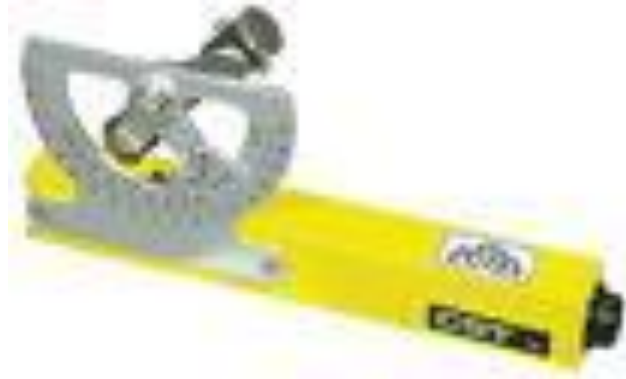
Figura 71. Clisímetro. Este instrumento no es tan complejo de utilizar así que el encargado del laboratorio de Topografía me asesoró y me dio instrucciones para poder utilizarlo.
