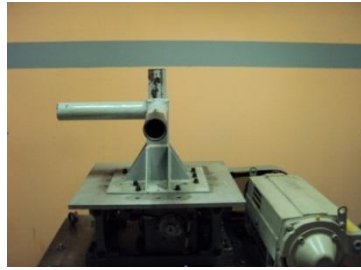
Figuras 47 y 48. Equipo para prueba de vibración a las luminarias
