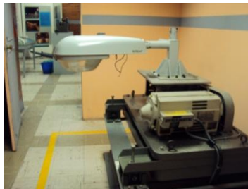
Figura 49. Luminaria lista para la prueba de vibración.
