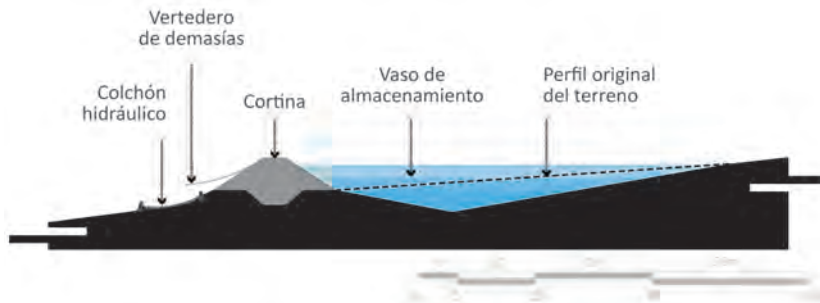
5.120 Bordo con cortina de tierra compactada. Corte AA'.
