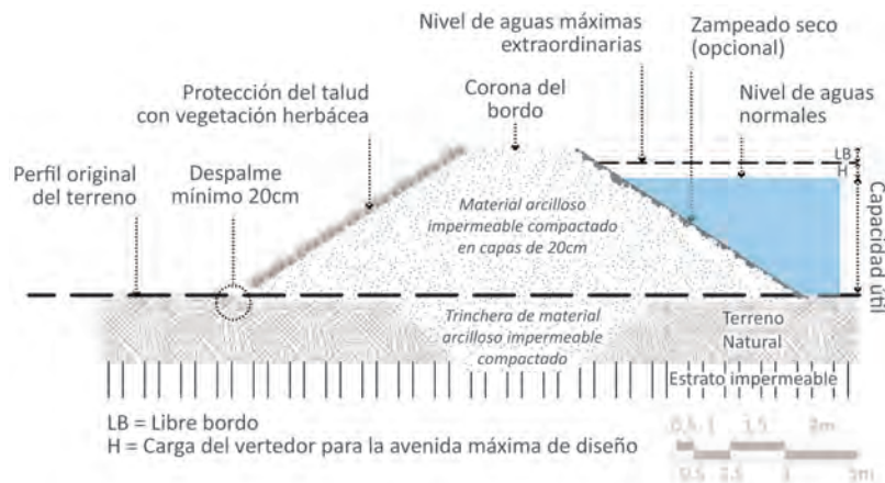
5.122 Cortina de tierra compactada. Detalle.
