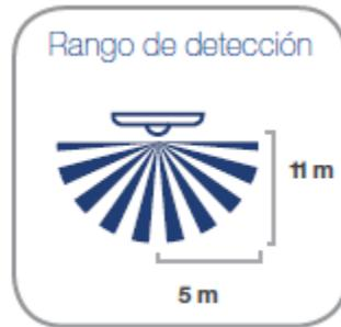
Figura. 5.7. Rango de detección del sensor de pared.
