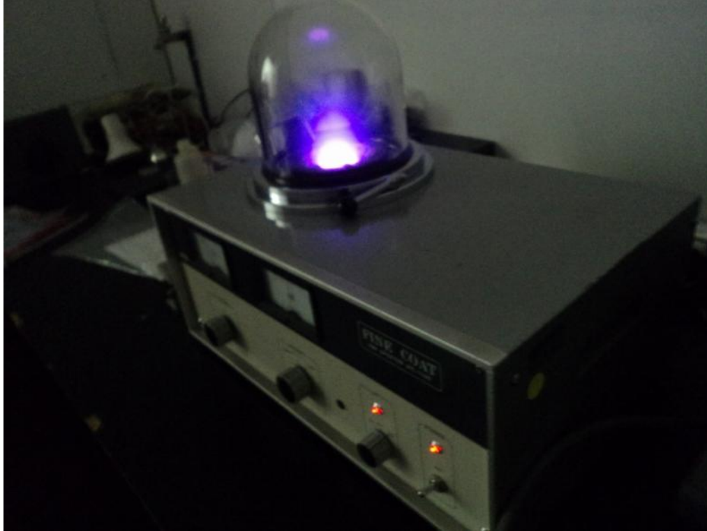
Figura 2.3. Evaporador al vacío JFC-1100 JEOL, las muestras de PET/PEN se están recubriendo de oro para realizar SEM.
