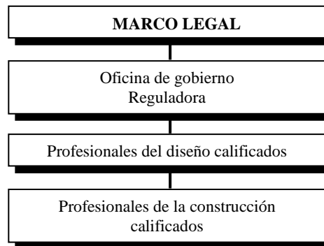
Figura 2.3 Componentes del sistema de seguridad estructural
