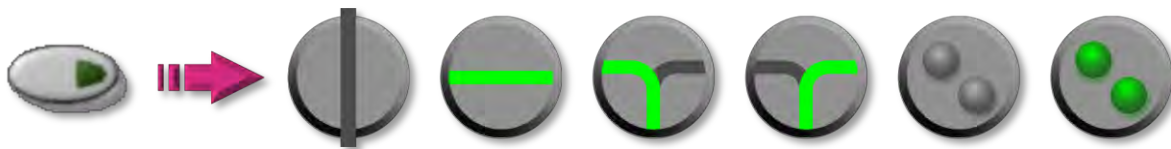
Figura 6-10 Personalización de un control estándar de LabVIEW para representar a una válvula solenoide.
