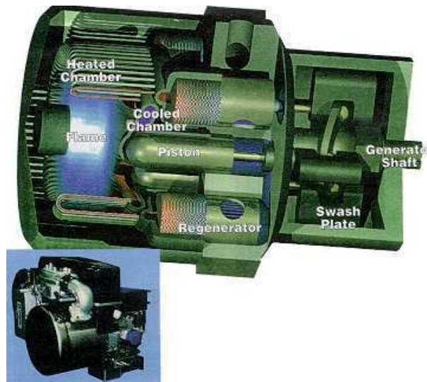
Figura 1.8 Motor Stirling desarrollado por GM.
