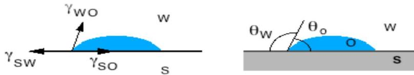
Figura 1.2 Medición del ángulo de contacto
