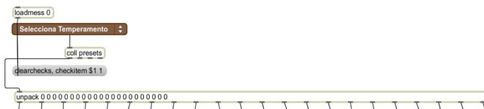
Ilustración 51 Selector de temperamentos de referencia conectado al objeto coll , que contiene la información de la desviación en cents de cada temperamento
