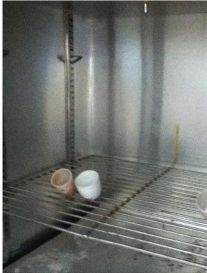
Ilustración 45. Crisoles en horno
