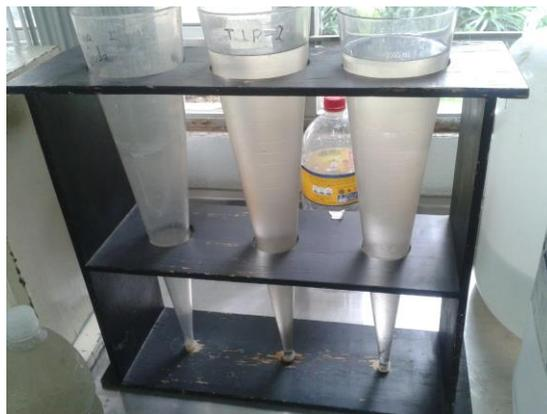
Ilustración 28. Prueba de Sólidos Sedimentables
