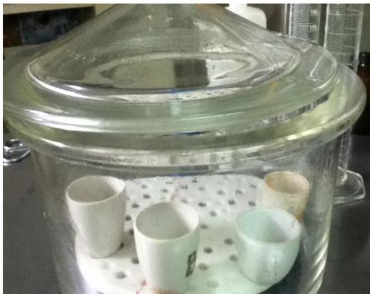
Ilustración 43. Enfriamiento de crisoles
