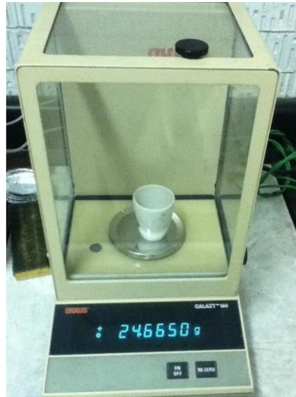
Ilustración 46. Pesado de crisol filtrado
