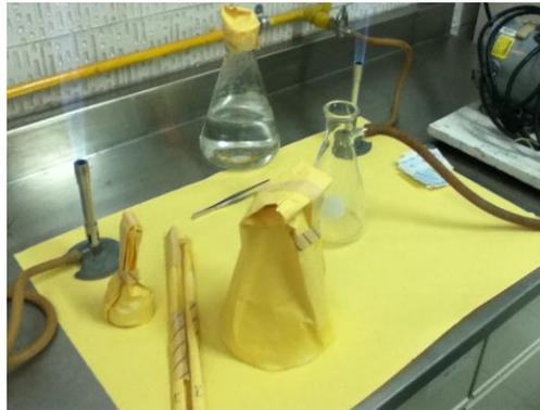
Ilustración 30. Equipo esterilizado
