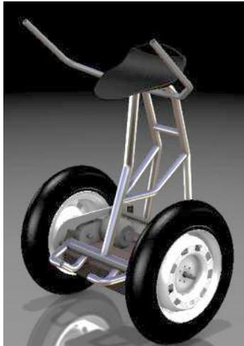
**FIGURA 3.9. Modelo en CAD del prototipo completo.**
