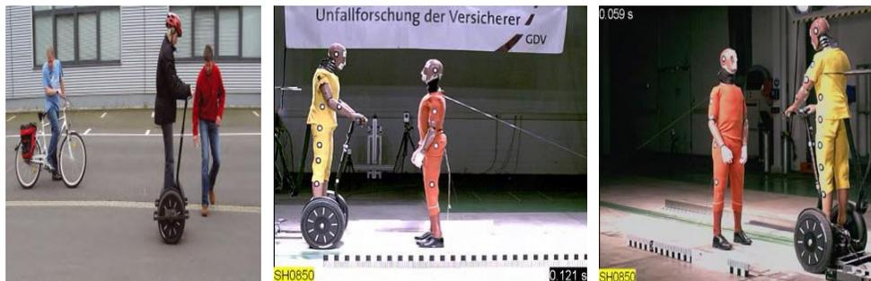
**FIGURA 2.1. Fotografías de las pruebas realizadas para determinar la seguridad del Segway, tomadas de [15].**
