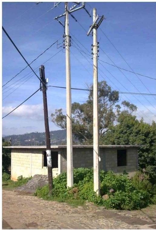
Figura 2.17: Fotografía de los postes de concreto con línea eléctrica y los de madera con línea telefónica
