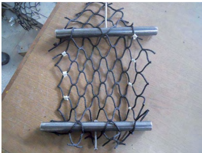
Imagen 30 Muestra de malla en sentido B (primer prueba, posteriormente se redujo 1 espacio para que la máquina de prueba pudiera deformarla lo suficiente.)
