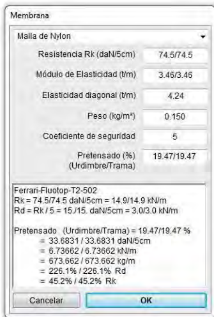
Fig. 11 Ventana de datos de membrana (en este caso malla) en software WinTess3.
