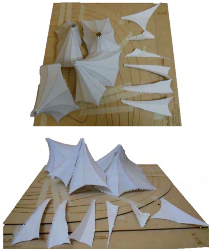
Imagen 24 Recorte y unión de plantillas en maqueta de estudio de papel.
