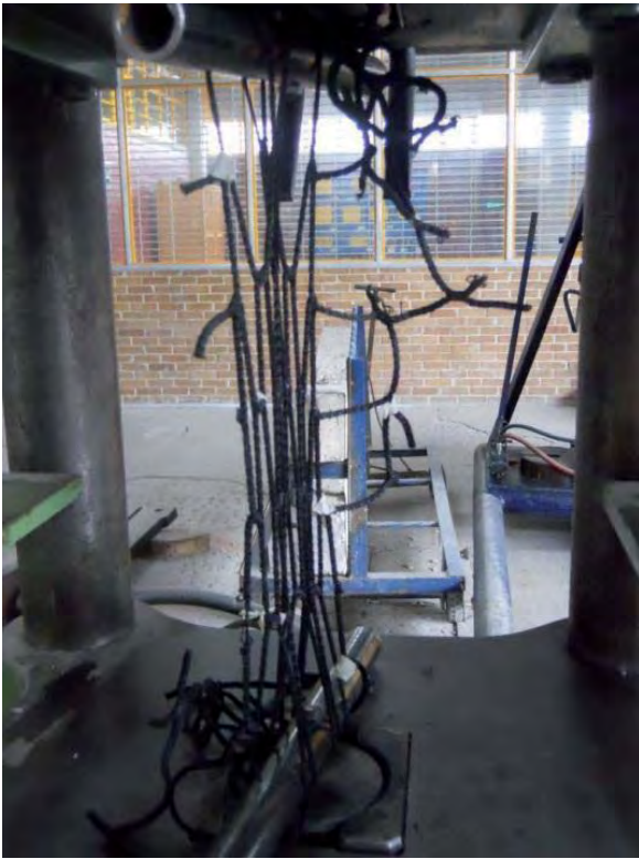
Imagen 29 Hilos rotos en sentido B
