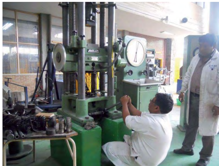
Imagen 33 Inicio de prueba a tracción en muestra de malla de nylon. La mordaza se presionaba con la palanca durante al inicio de la carga aplicada.
