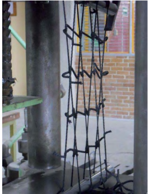
Imagen 25 Malla deformada en sentido A.
