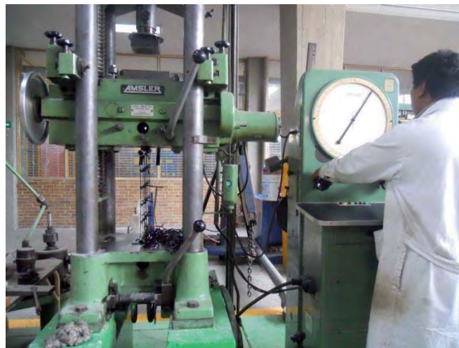
Imagen 27 Maquina de prueba utilizada en ensayos a tracción de malla.
