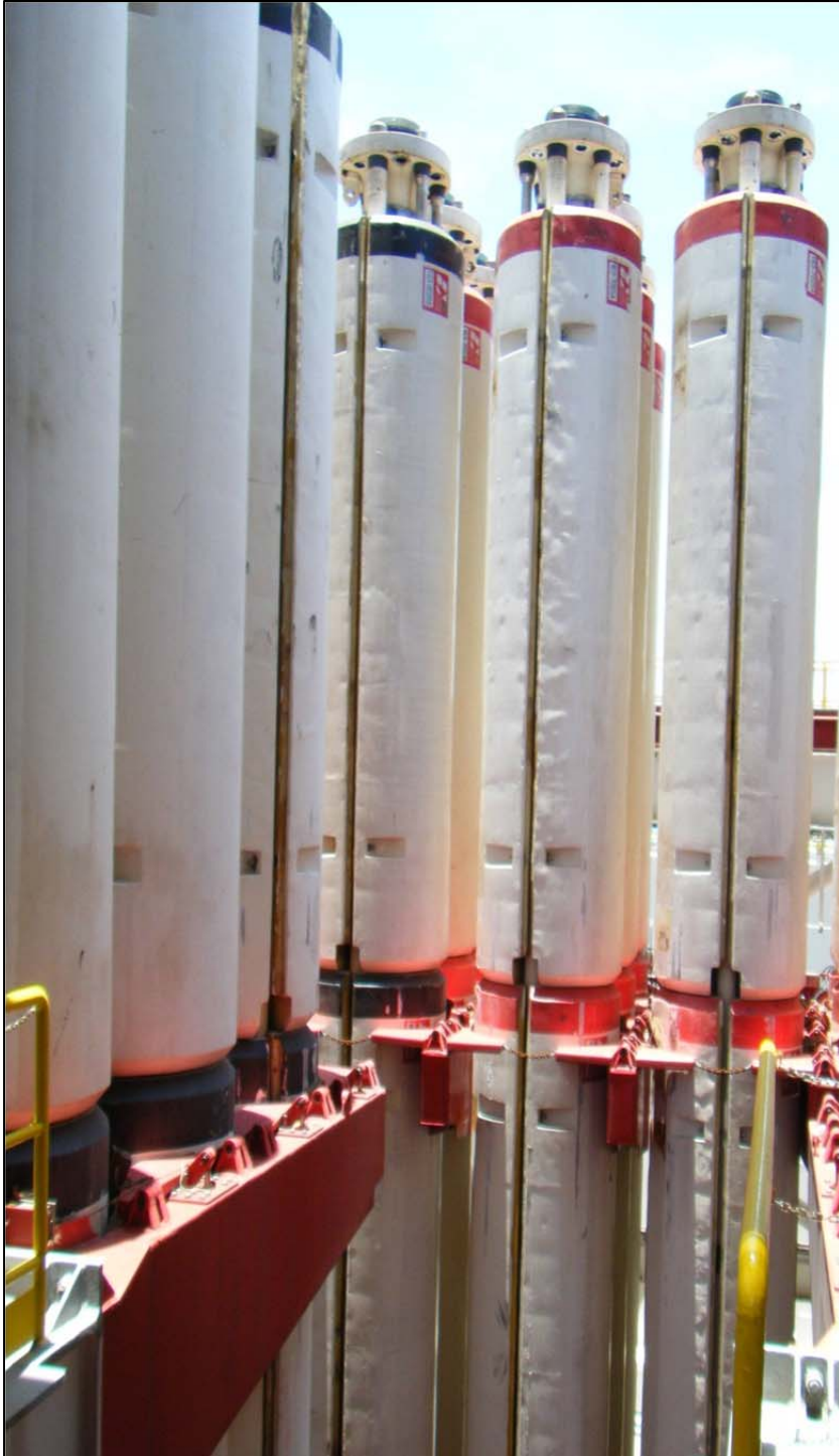
Figura 5.13 Los Riser ó conductores marinos se encuentran cubiertos por materiales especiales que logran mantenerlos a flote.
