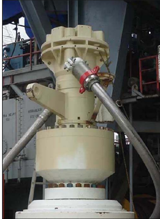
Figura 5.36 Conexiones de la línea de estrangular y matar.
