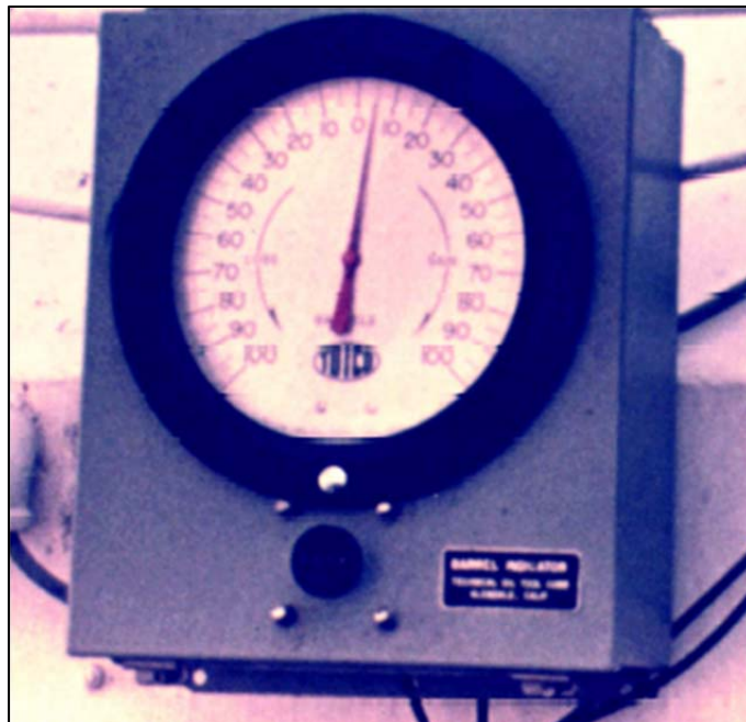
Figura 5.3 Totalizador de volumen de presa de lodos.
