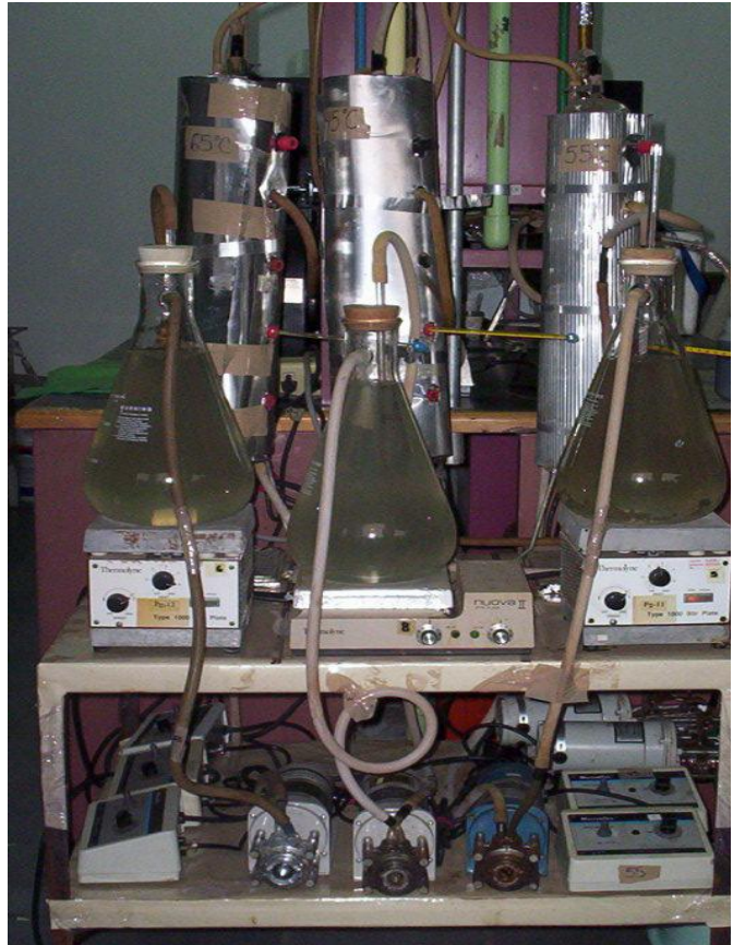
Fig. 7 Reactores UASB/RALLFA utilizados en la experimentación
