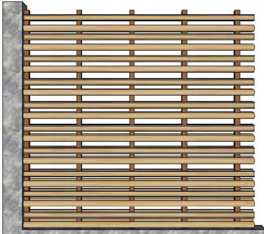
ALZADO DE MURO DE BAMBÚ
