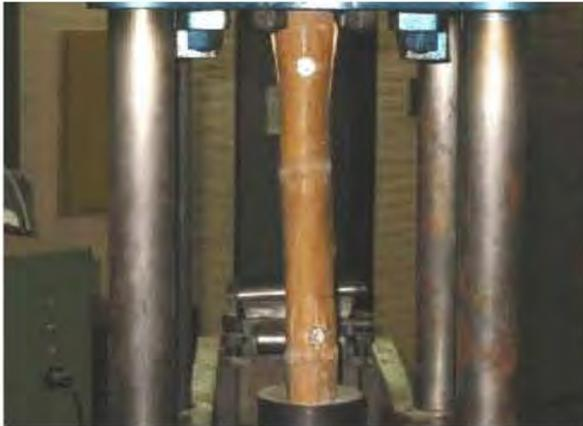
Fotografía C Resultado de ensayo de sección compuesta unida varilla roscada de acero y relleno de concreto.
