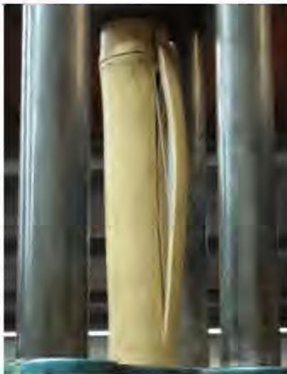
Fotografía A. Muestra Resultado de ensayo de compresión – Sección entre dos nudos.
