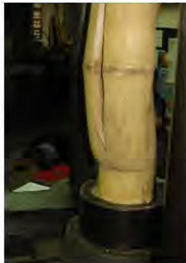
Fotografía B Resultado de ensayo de compresión – Sección con un solo nudo intermedio.
