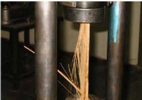
Fotografía F Resultado de ensayo de tracción.
