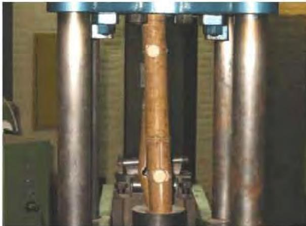
Fotografía D Resultado de ensayo de sección compuesta unida con tarugos de madera.
