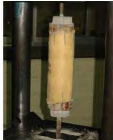
Fotografía E Resultado de ensayo de sección rellena de concreto.
