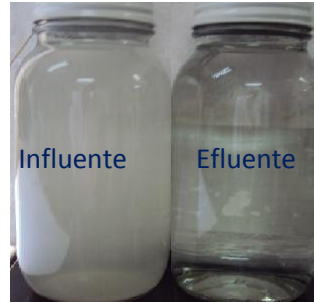
Figura 6. 21 Comparación del agua inicial (efluente del proceso de Floculación DAF) vs final (después del proceso de ultrafiltración).
