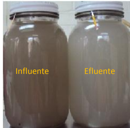
Figura 6. 24 Comparación del agua inicial (efluente de los separadores API-4) vs final (después del proceso de ultrafiltración).
