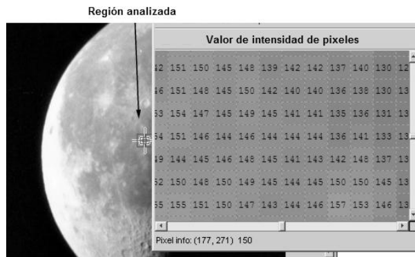
Figura 71. Representación por medio de píxeles de una imagen monocromática. [18]
