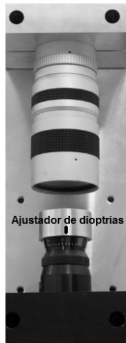
Figura 65. Ajuste de dioptrías telescopio de alineación.
