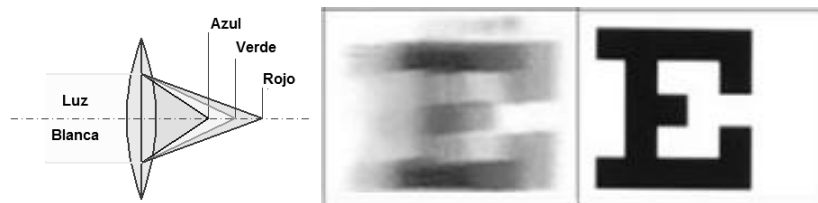
Figura 35. Ejemplo de aberración cromática. [13]
