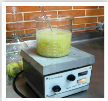
Figura 3.2 — Mezcla calentada por 1 h a 90° C, con agitación constante
