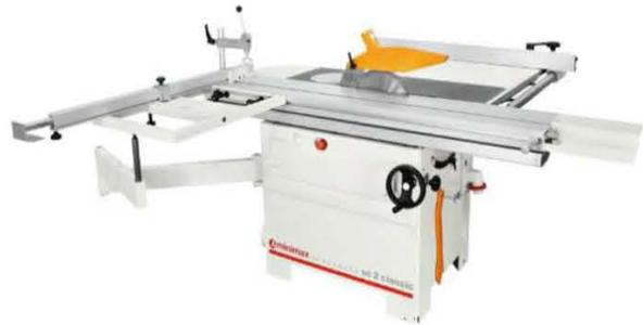
*Esta sierra nos permitirá hacer cortes longitudinales para sacar secciones de madera a lo largo de diversos espesores y anchos es decir cortes al hilo (veta de la madera a lo largo de una tabla o tablón)*
