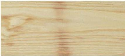
Color típicamente gris producido por rastreles utilizados para el secado de la madera.
