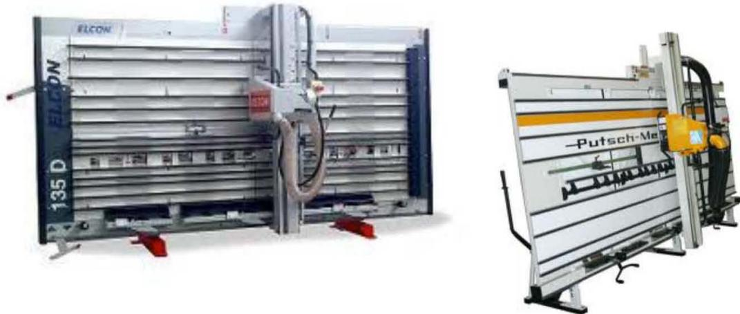
*Los cortes que hace al tablero son en el sentido vertical u horizontal sobre un bastidor metálico con rodillos para un buen deslizamiento con el que cuenta esta sierra, la gran ventaja de esta máquina es que el espacio que ocupa es mínimo ya que va adosada a la pared. Su motor esta tan revolucionado como el de un Router por lo que sus cortes son limpios y no dejan astilla al cortar en el sentido transversal.*
