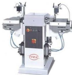
Esta máquina tiene la ventaja de hacer mecánicamente lo que antes se hacía manualmente. Es hacer escoplos y cajas para puertas, ventanas, sillas, mesas, etc.
