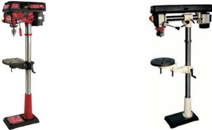
*El cabezal es donde se encuentra el motor que hará girar el eje donde se encuentra el broquero que determinara el espesor de la broca a usar. por lo tanto esta es la pieza principal de esta herramienta; también contamos con diversas poleas para girar la broca a 600 rpm, 1300 rpm, 2400 rpm y 5000 rpm. La cualidad de este movimiento es que podremos hacer agujeros superficiales, de mediana profundidad con gran profundidad así como vaciar cajas para escoplos de patas, mesas sillas, puertas, etc.*
