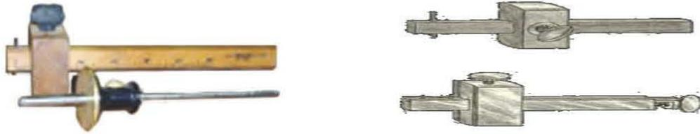
*Gramil de metal y de madera con punta seca ambos operan con un tornillo para apretar el vástago*
