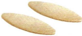
*Pedazos de madera de haya cortada a troquel. Estos ensambladores de madera (o placas de unión de madera) son comprimidos para proporcionar firmeza y rayados para mejorar la unión con pegamento. Cuando se utilizan con cualquier pegamento a base de agua, la madera se hincha en la unión proporcionando una excelente fuerza de adherencia.*
