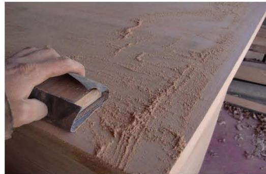
*Diferentes tipos de lija y pulido de una superficie de madera*
