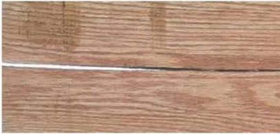
Separación longitudinal en la madera generada durante su proceso de secado.
