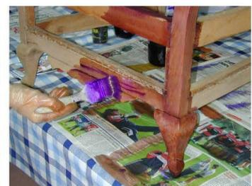
Procedimiento para entintar la madera (disolución y aplicación de color)
