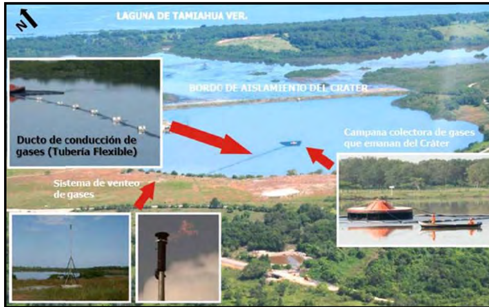
Figura III. 6. Campana colectora y sistema de venteo de gases del pozo San Diego de la Mar-3 (Tomada de Pemex, 2008).
