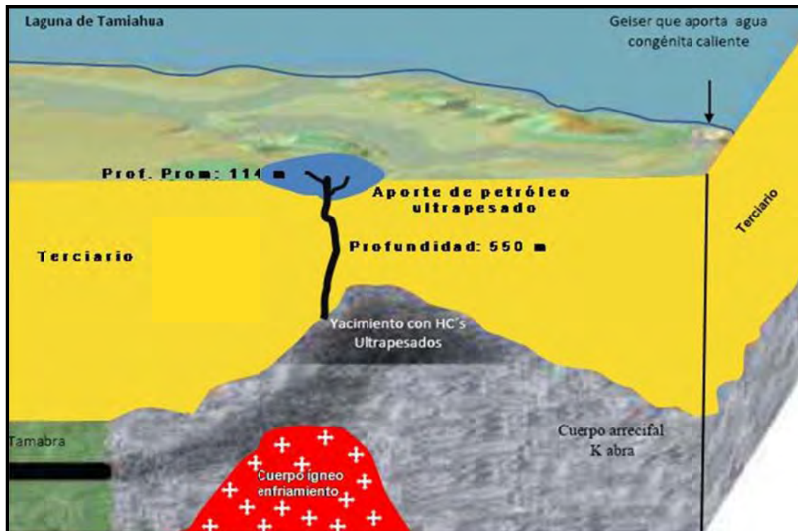
Figura III. 2. Causas de la formación del Cráter de Dos Bocas (Modificada de Pemex, 2008).
