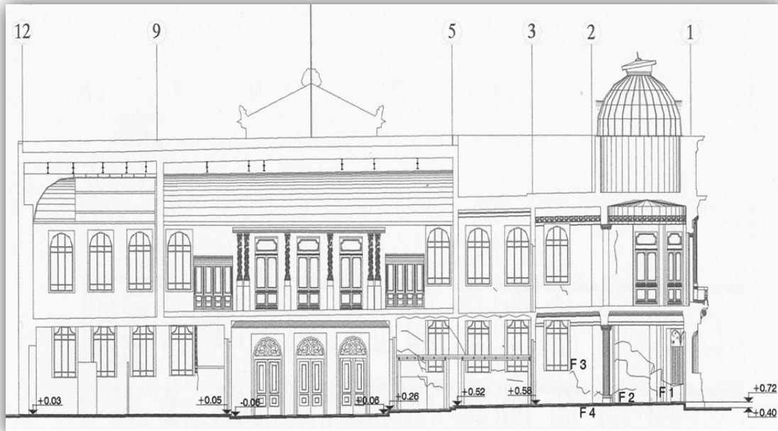
Figura 2.74. Levantamiento de grietas en la fachada Oeste (2007), corte A – A' [2.17].
