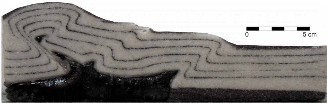
Figura 6.25. Corte del modelo 7 con resultados similares al anterior (experimento 6), que refieren estructuras de vergencia en dirección del transporte tectónico.
