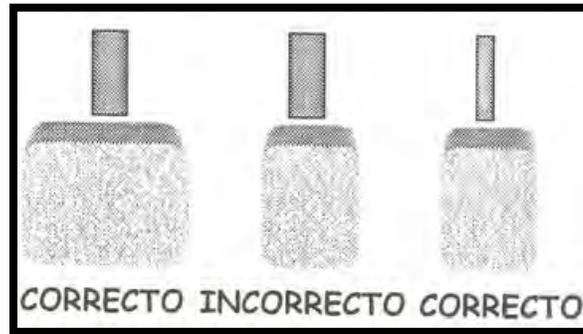
**Figura 10.** Posición correcta del material utilizada en prueba de punción.
