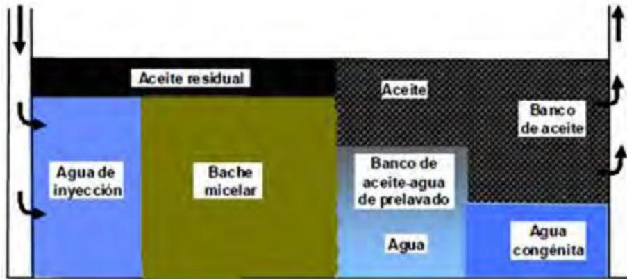
Figura 1.18: Procedimiento de inyección de soluciones micelares.
