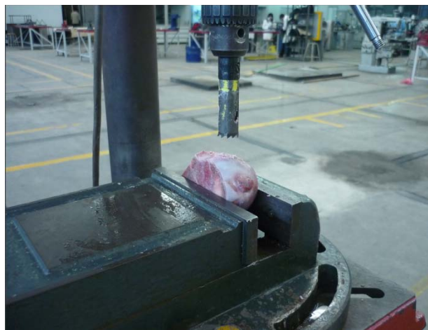
Figura 3.4 Obtención de la probeta para análisis microestructural.
