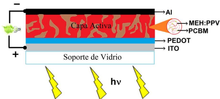
Fig. 10. Esquema de una BHJ-OPVd
