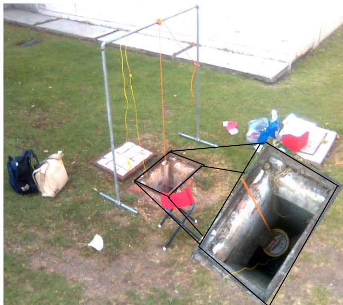
Figura A1-3. Mecanismo de aforo y muestreo
