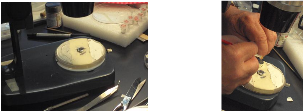
Figura IV-10. Colocación de las muestras secas en las cápsulas de aluminio
