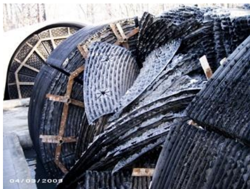
Figura II-10. Falla estructural del material de fijación. Fuente desconocida
