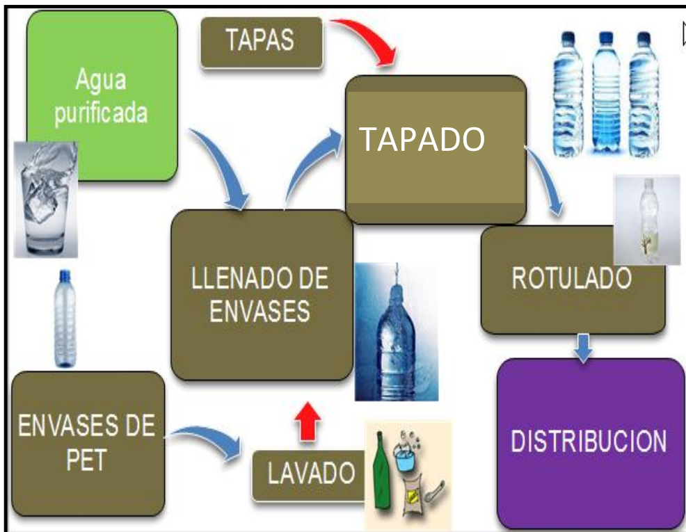
Ilustración 5. Proceso de Envasado de Agua.
