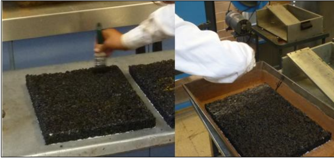
Figura j. Empleo de riego de liga para despues colocarle el poreo
