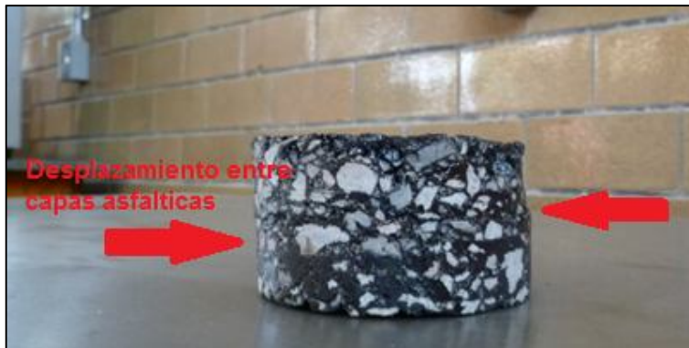
Fig. 25 Probeta con ensayo de corte LCB
