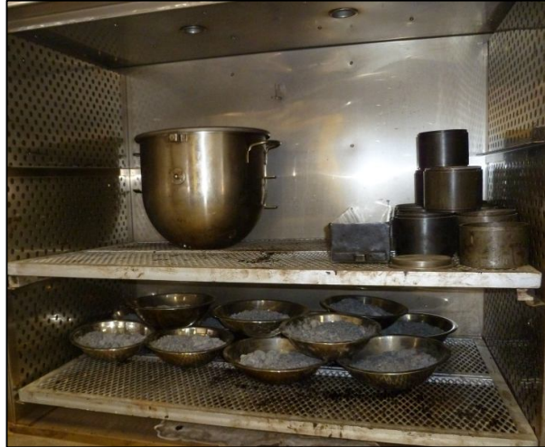
Fig. 45 Equipo de trabajo colocado a una temperatura de 150 °C ( ^{\circ} C), listo para mezclar
