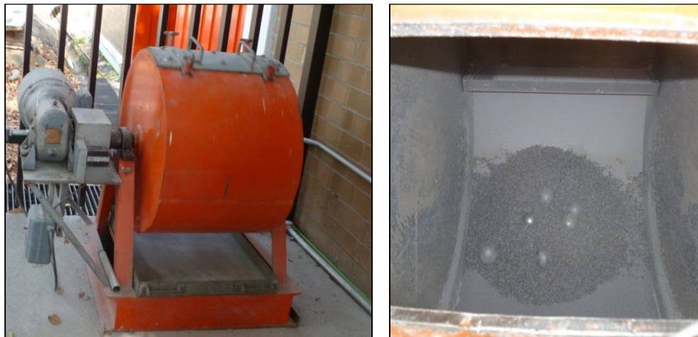
Fig. 33 Desgaste mediante la prueba de los Ángeles
