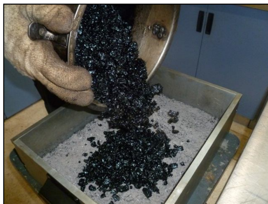
Fig. 54 Vaciado de mezcla asfáltica sobre el poreo de una placa densa
