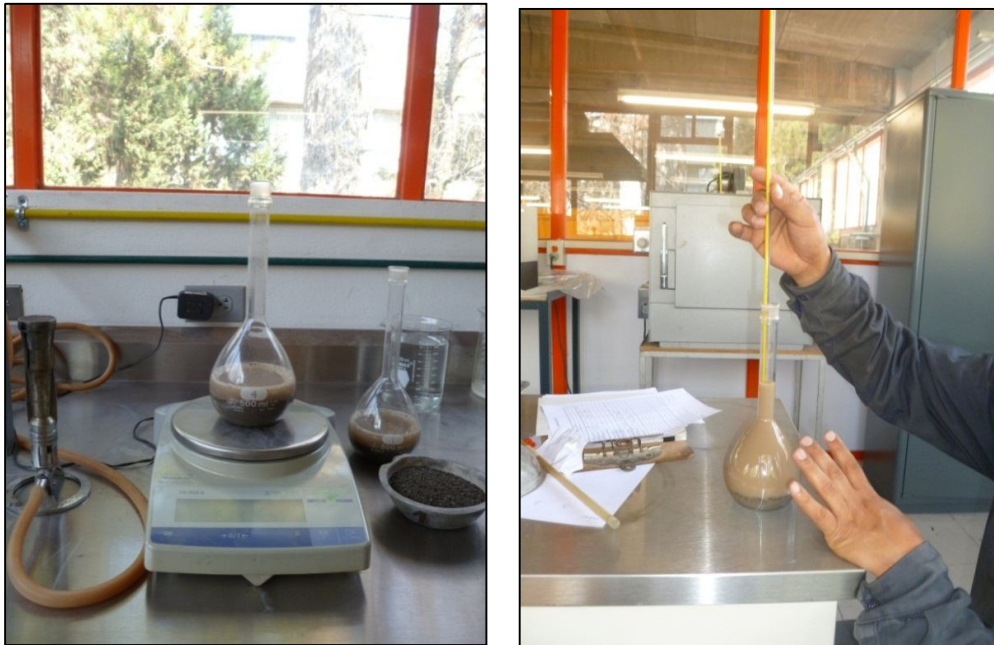
Fig. 29 Prueba de Densidad en Agregados Finos
