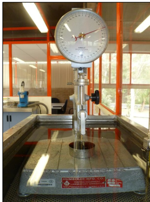
Fig. 34 Prueba de Penetración
