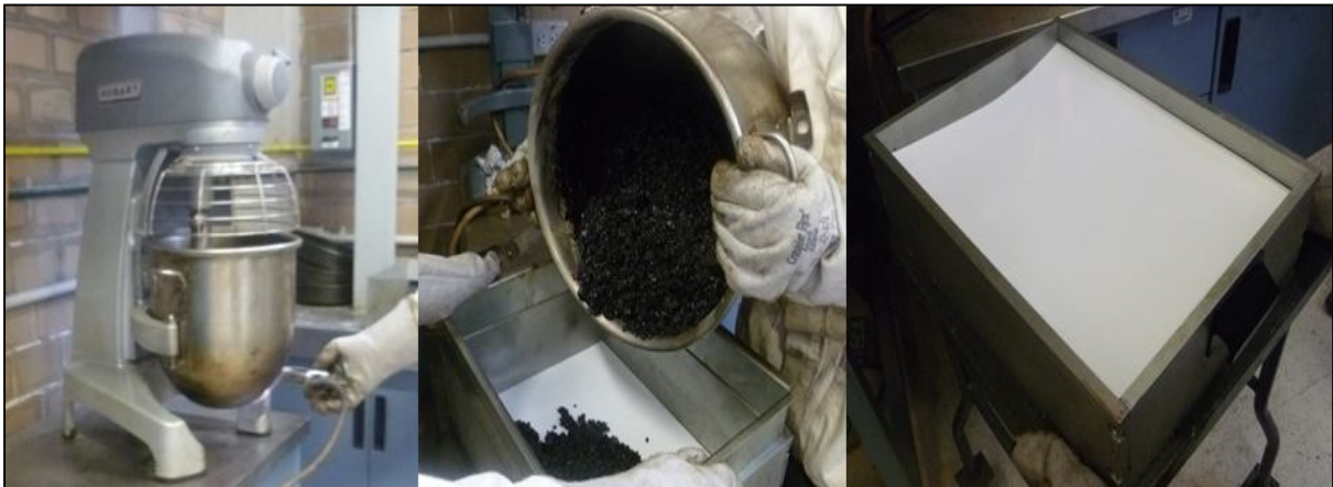
Figura f. Mezclado y vaciado de mezcla asfáltica
