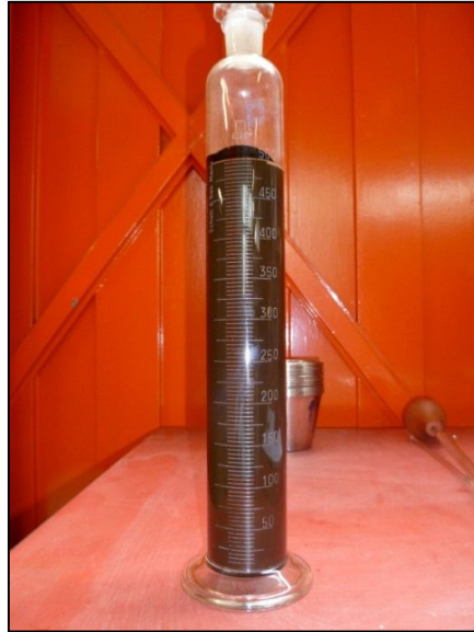
Fig. 38 Prueba de Asentamiento
