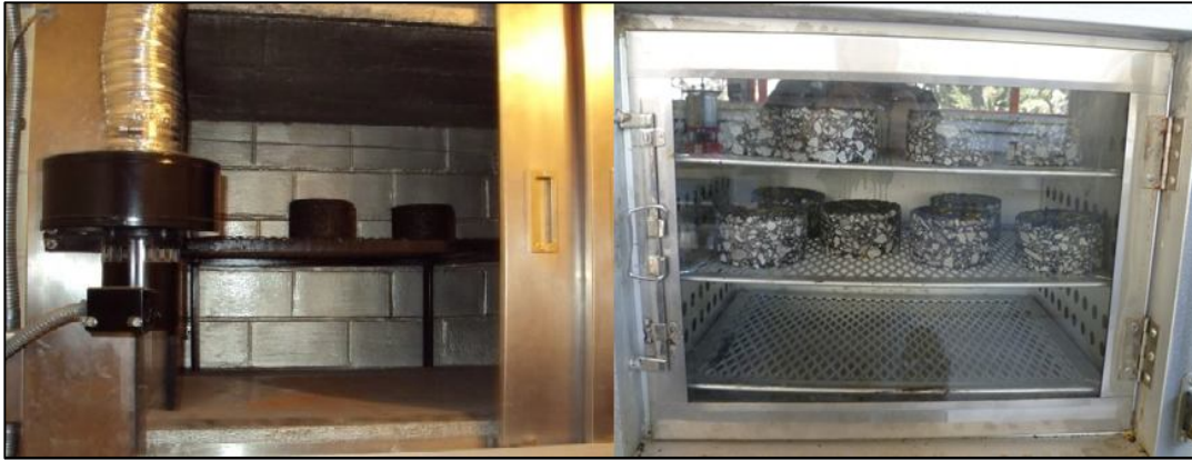
Figura l. Testigos condicionadas a temperatura de 25°C y a 40°C.
